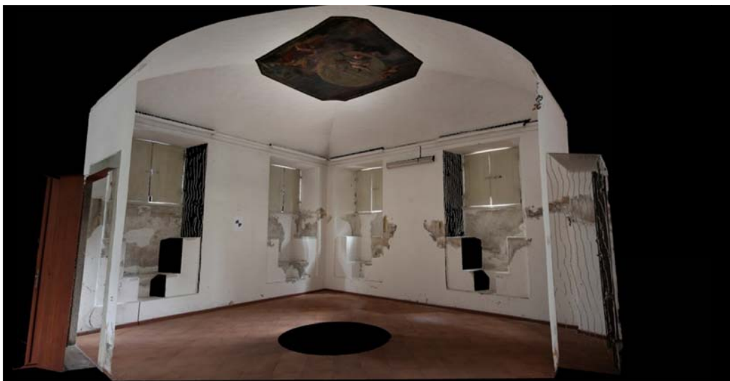
Figura 2 - Scansione Laser 3D con riproiezione del colore acquisito fotogrammetricamente
